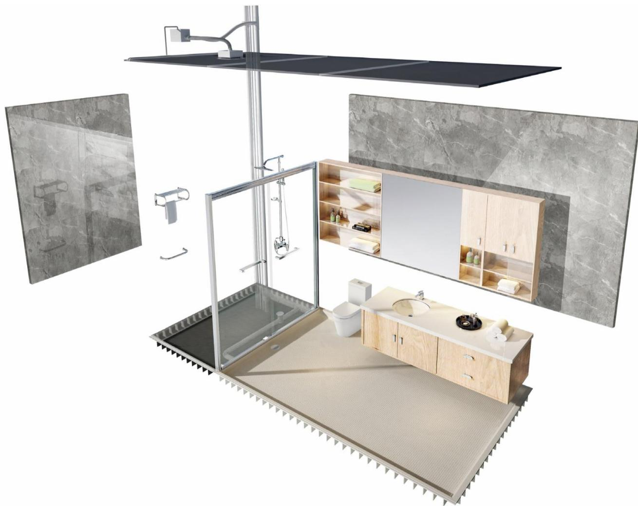
装配式卫生间，国际上，被称为 Unit Bathroom或System Bathroom，国内被称为整体浴室、整体卫浴、整体卫生间、系统卫浴、装配式整体卫浴、预制式整体浴室等。是指采用一体化防水底盘、壁板及顶板构成卫生间主体框架，集合坐便器、浴缸、洗面台、浴室收纳柜、淋浴屏等功能洁具形成独立的卫浴单元，在有限的空间内实现便溺、盥洗、沐浴、收纳等多种功能。
